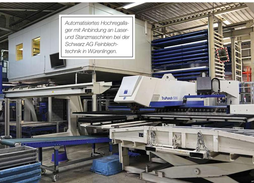
Automatisiertes Hochregallager mit Anbindung an Laser- und Stanzmaschinen bei der Schwarz AG Feinblechtechnik in Würenlingen.
